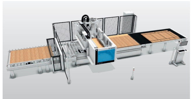
Konzept 2R+ Einlaufrollenbahn als Schnittstelle für vorgelagerte Automatisierungen
